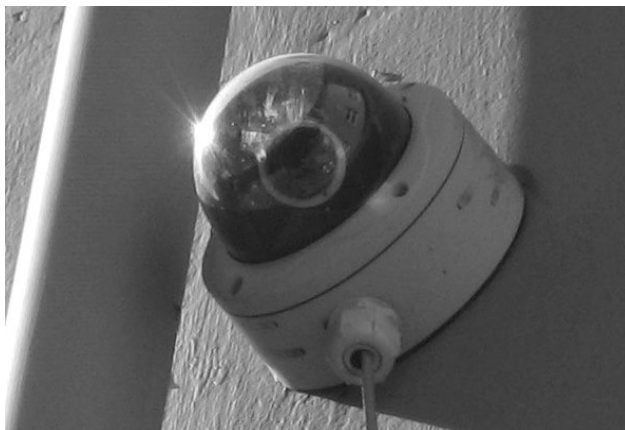
Mynd 1. Þessi tegund öryggis- og eftirlitsmyndavéla kallast „dóma“. Inni í hálfkúlunni er myndavél sem ekki sést glögglega hvert beinist. Stefnu sumra þeirra má fjarstýra og beina í ólíkar áttir. Þeim má beina mun hraðar en hefðbundnum öryggis- og eftirlitsmyndavélum. Þær síðarnefndu henta að jafnaði betur til almenns eftirlits á ákveðnum svæðum en dómurnar eru betur til þess fallnar að fylgjast með einstökum mannaferðum (Viðtal 8)
